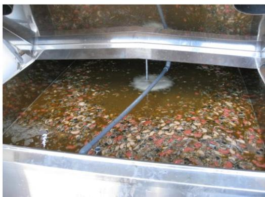
図 5c ホタテウロ溶解槽
